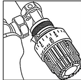
**Внимание!** Отключение радиатора от гидравлической сети при его демонтаже термоголовкой не допускается!
