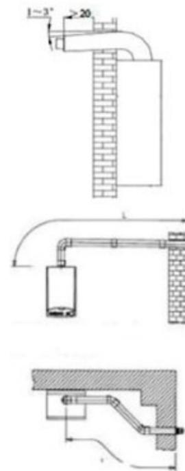
Труба должна иметь минимальный наклон по направлению от котла во избежание попадания конденсата. Максимальная длина дымохода не должна превышать 5 м., данный параметр может быть иным в зависимости от требований изготовителя отопительного оборудования.
